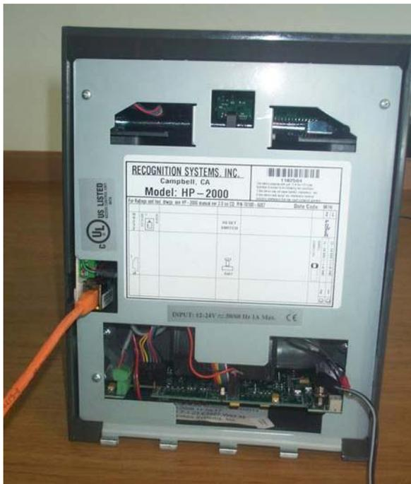
Al concluir esta instalación proceda a instalar el programa para la configuración y asignación de la dirección IP del convertidor **TCP/IP Micro** (Vea la sección de **Pasos para configurar los convertidores TCP/IP Micro y TCP/IP Compacto**)
