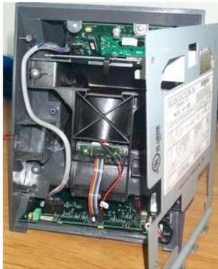
**Paso 3:** Instale el convertidor **TCP/IP Micro** en el *Hand Punch* como se muestra en la siguiente figura:
